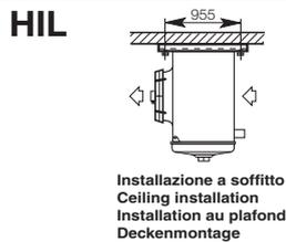
Gli aeroregolatori HIL sono forniti con una struttura da usare per il montaggio a soffitto. La stessa struttura è utilizzabile per l'installazione a pavimento.
