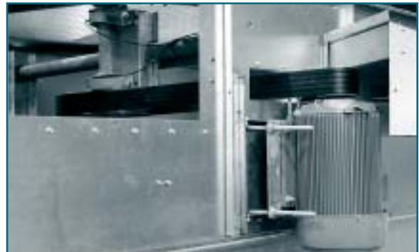
Außen montierter Motor
