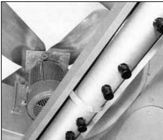
*Ventilatorsystem mit Direktantrieb*
